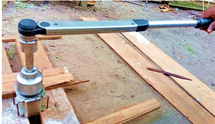
Figura 47 – Procedimento de calibração do limitador de torque
