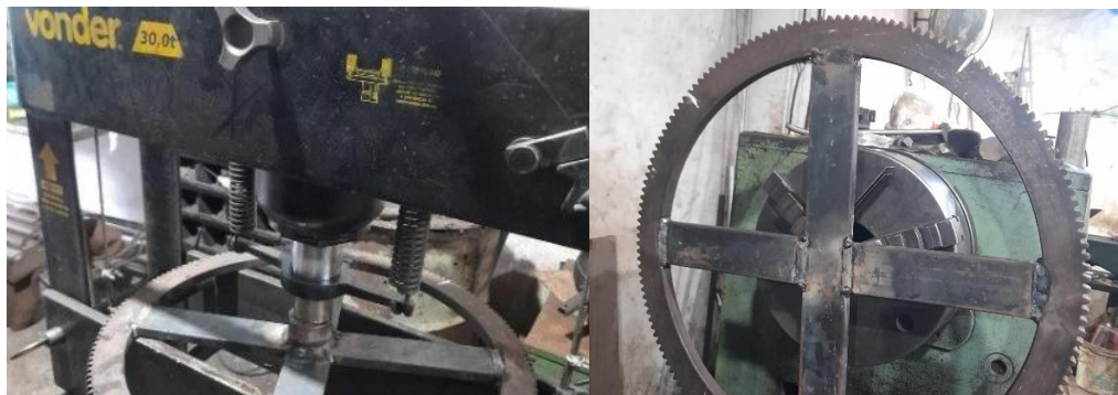
Figura 54 – Soldagem e acabamento dos acoplamentos
