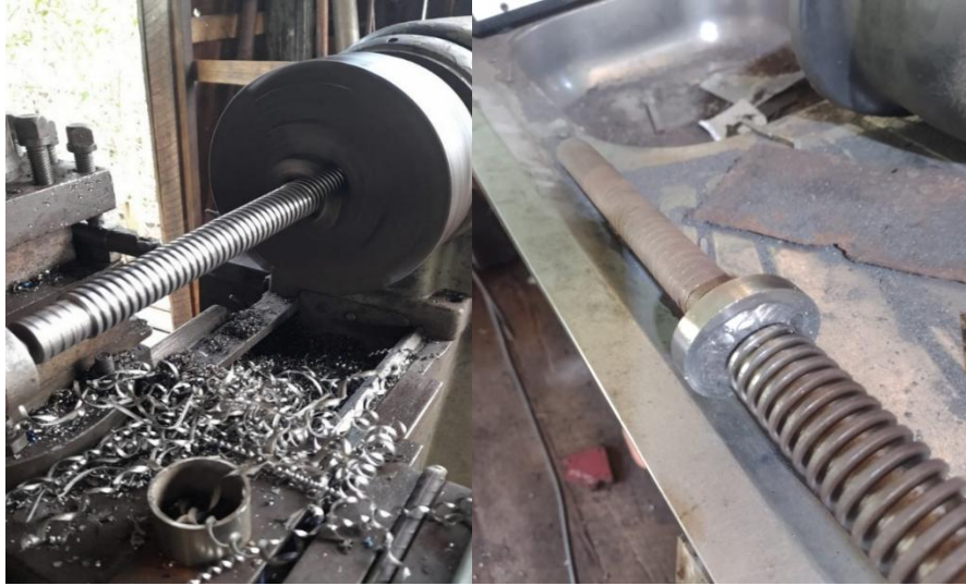
Figura 50 – Usinagem do fuso para o acoplamento das engrenagens e mancais
