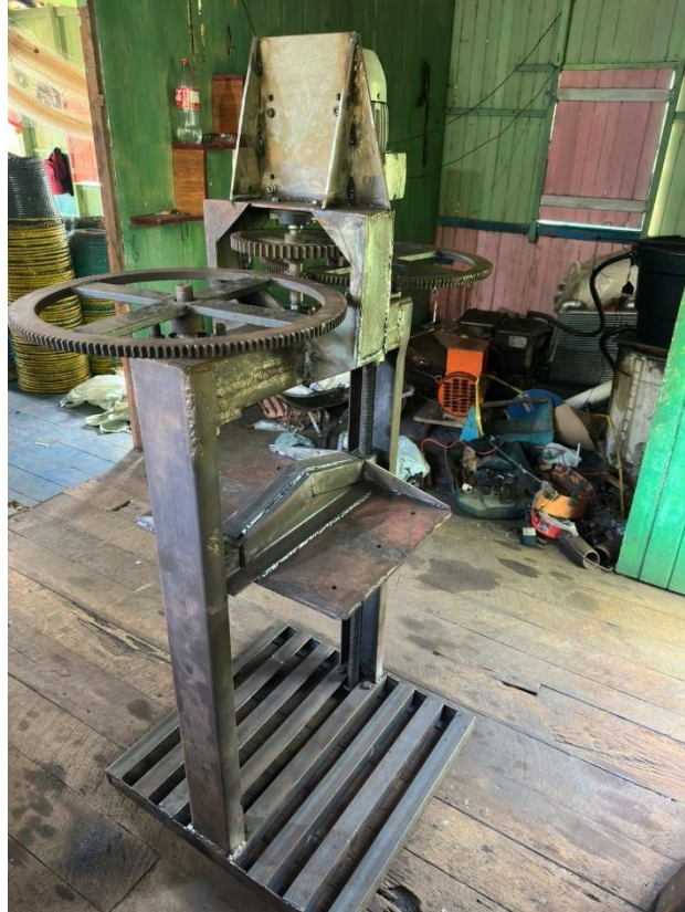
Figura 51 – Fabricação e montagem da mesa móvel e suporte do motor
