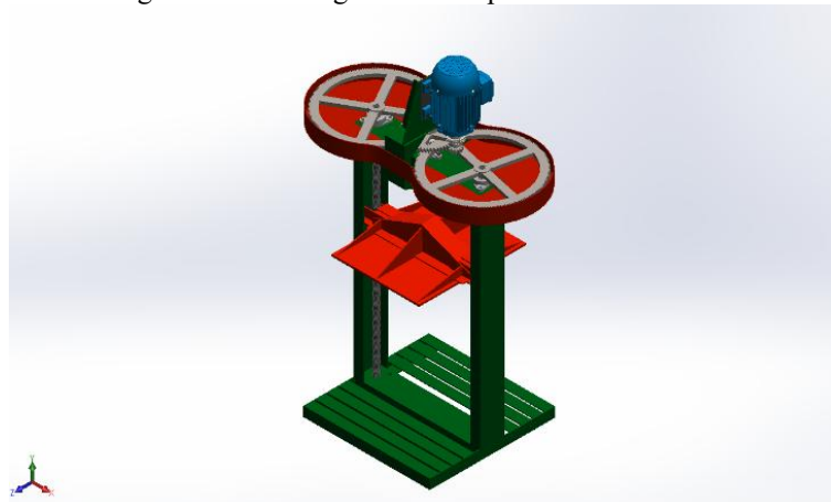
Figura 23 – Montagem final da prensa eletromecânica
