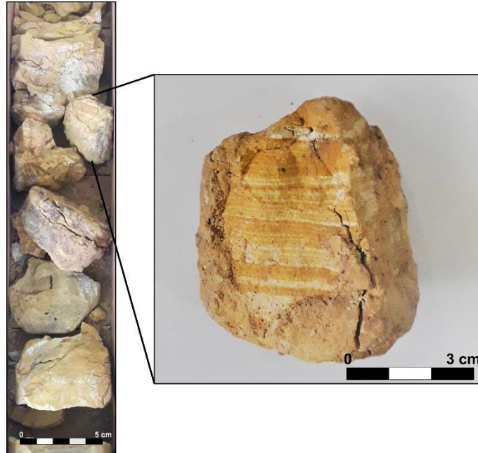
Figura 7- Laminação plano-paralela sobre arenito da fácies Ap. Notar a alternância de coloração entre as lâminas, que destaca também ligeira diferença de granulometria.
