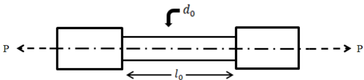
Figura 12 – Ilustração do corpo de prova sobre o ensaio de tração
