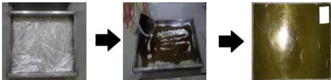
Figura 9 – Fluxograma da produção dos compósitos
