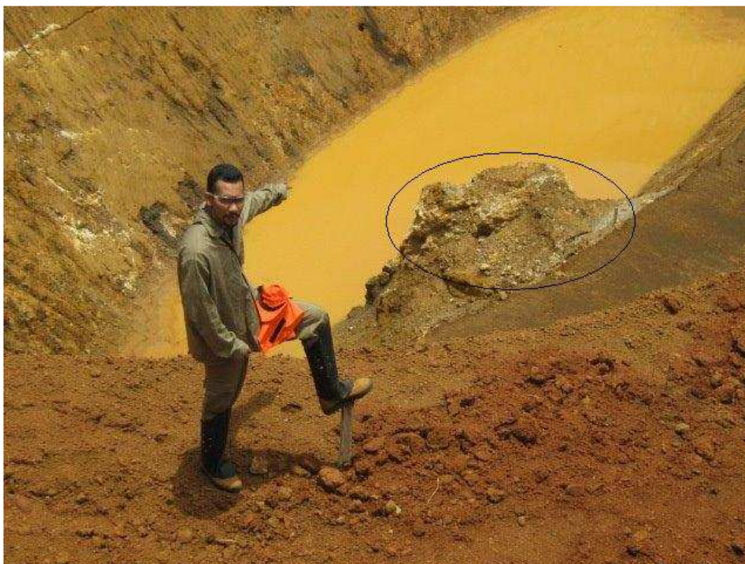
Figura 2.2 – Cava da jazida com lago formado no seu fundo destaca-se a presença de foscorito (no círculo).
