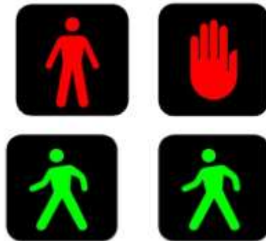
Figura 2.25: Cores, forma e pictogramas do GF de pedestres
