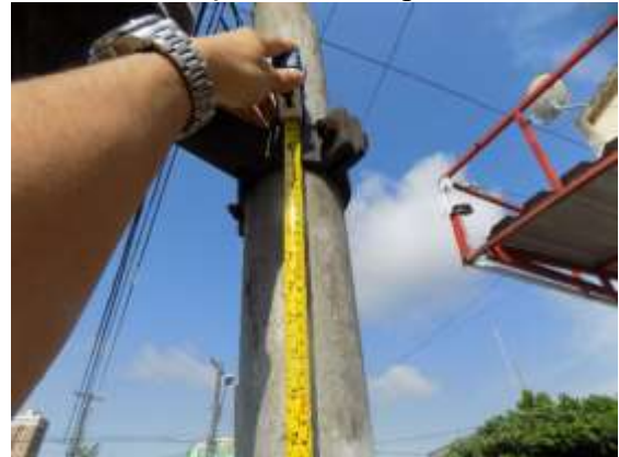
Figura 3.7: Medição manual da altura de sustentação de GF de pedestres
