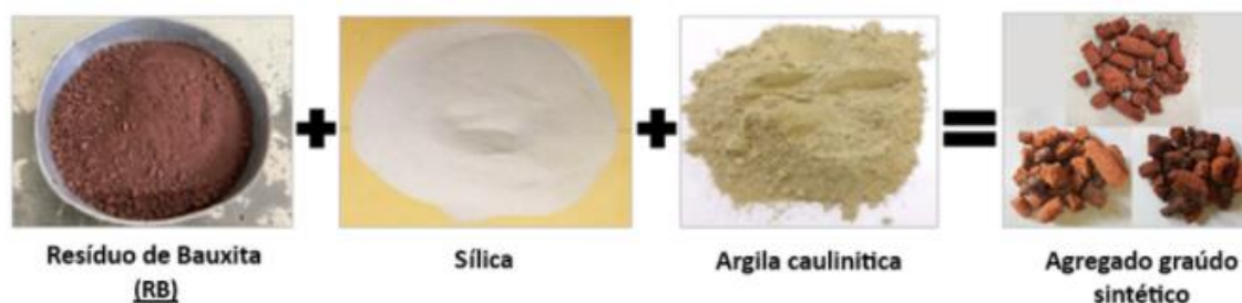
Figura 2 – Materiais primários utilizados para a produção do agregado sintético
