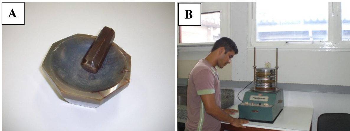
Figura 3 – Desagregação e peneiramento das amostras. A) Graal e pistilo de ágata, utilizados nas desagregações das amostras; e B) Peneiramento das amostras nas malhas 0,062-0,125mm e 0,125-0,250mm.
