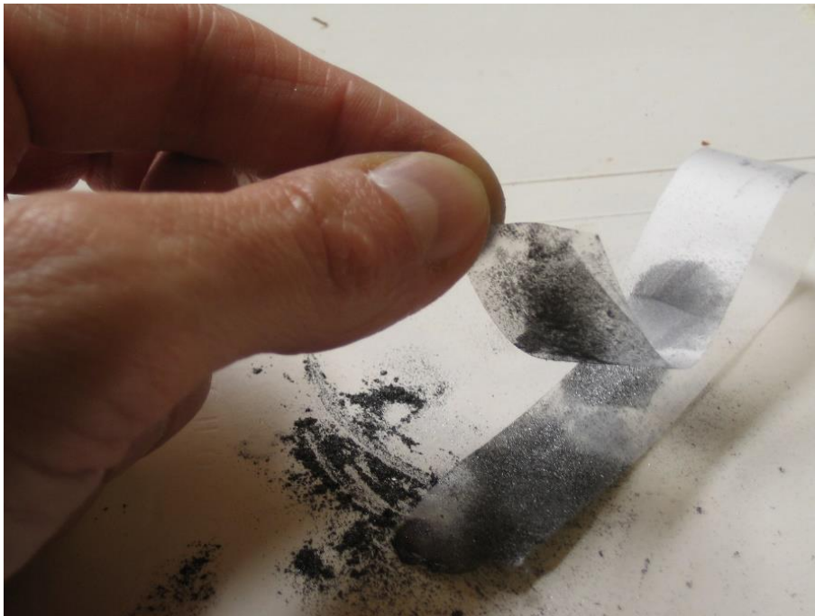
Fig. 8 Método de esfoliação mecânica para obter grafeno. (Reproduzido de [39]).
