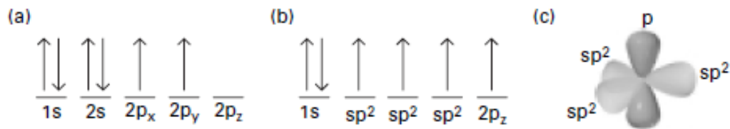
Fig. 1 Esquema que apresenta a distribuição eletrônica na camada de valência e os spins para: a) átomos de carbono, b) grafeno, onde um elétron do orbital s e dois dos orbitais p formam três orbitais híbridos entre si e em c) é ilustrado esses orbitais. (Adaptado [20])
