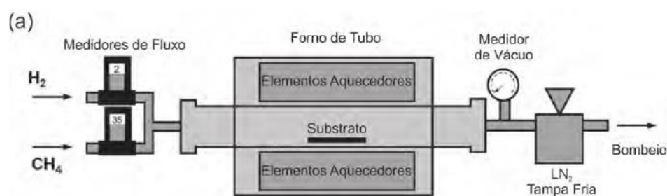
Fig. 9 Aparato para crescimento de grafeno por CVD de baixa pressão. (Adaptado de [41]).
