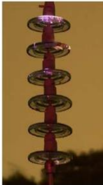
Figura 2.10 – Efeito corona em isoladores poliméricos
