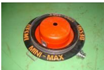
Figura 37 -Recolhedor tipo Vortex - acoplado às bombas SPATE remove hidrocarbonetos de corpos hídricos
