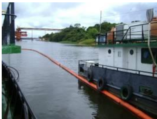
Figura 34-Detalhe da balsa Barix com a barreira de contenção.
