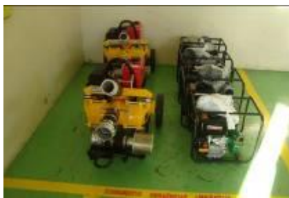
Figura 35 -Bombas SPATE , em amarelo específicas para remover óleo de corpos hídricos.
