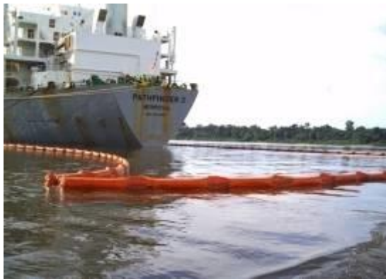
Figura 32- Barreira de contenção na popa onde estão instaladas a casa de máquina e os principais tanques
