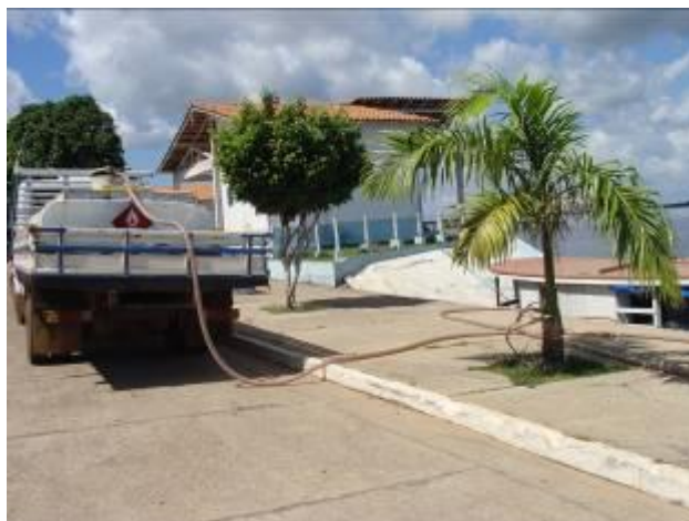
Figura 47 -Operação comum de transferência de combustível para embarcação,em Terra Santa .
