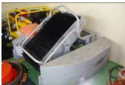
Figura 36 -Recolhedor Mecânico para remoção de hidrocarbonetos de corpos hídricos.
