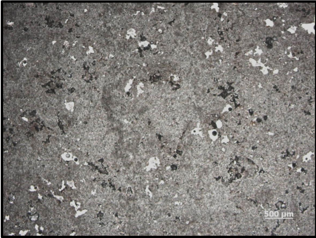
Figura 59 - Porosidade móldica influenciada por formação de poros vugs . Notar as bordas, anteriormente retas, corroídas. Nicóis paralelos.
